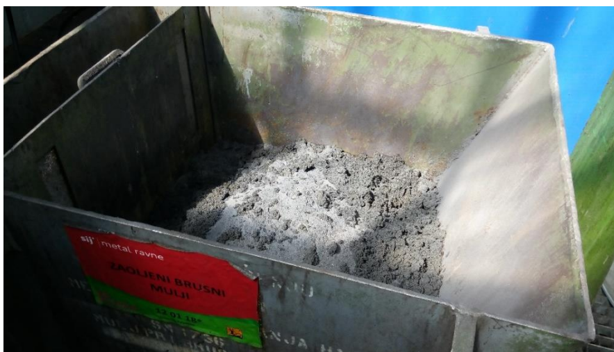
Slika 13: Posoda za zbiranje zaoljenih brusnih muljev v valjarni
