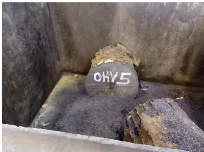
Slika 16: Kovinski del, ki je primeren za ponovno uporabo, preden se ga odpelje na pripravo vložka. Na njem je napisana kvaliteta materiala – sestava jekla
