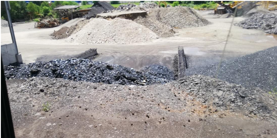
Slika 9: Ločeno skladiščenje na Haldi (levo škaže, desno mleta žlindra)
