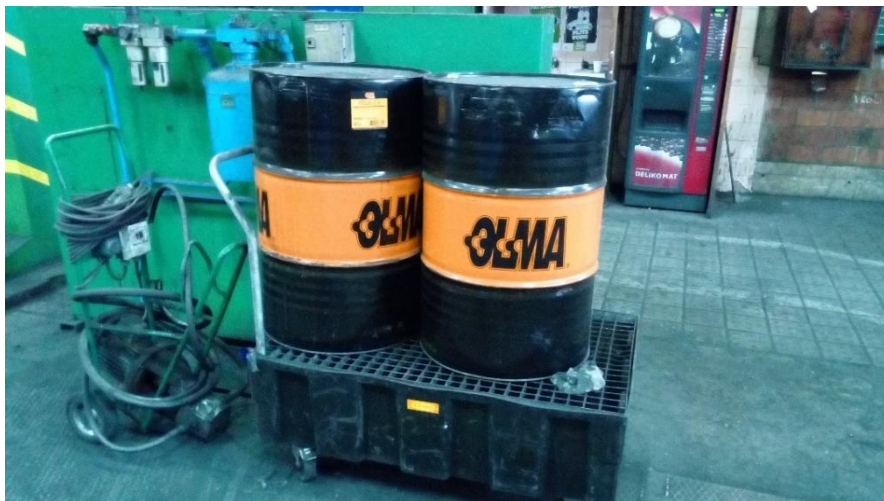
Slika 11: Primer lovilne posode, ki se uporablja pri sodih za odpadna olja
