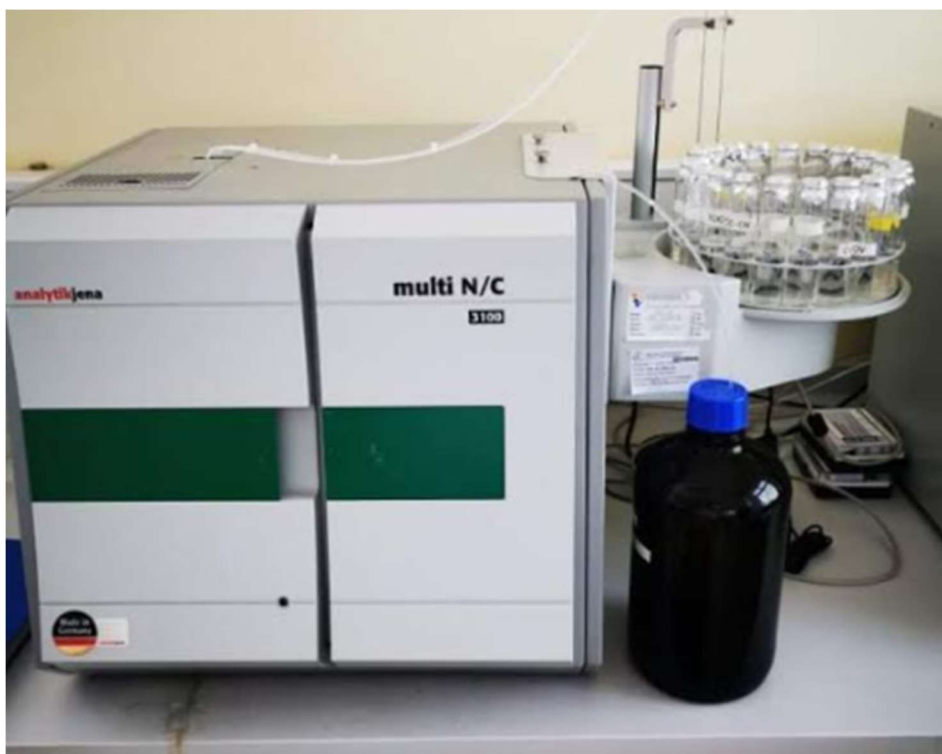
Slika 9: Aparatura za določevanje celotnega organskega ogljika in vezanega dušika (Jesenek, 2021)
