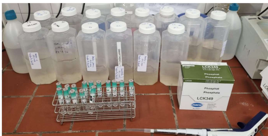
Slika 10: Določanje celotnega fosforja (Jesenek, 2021)
