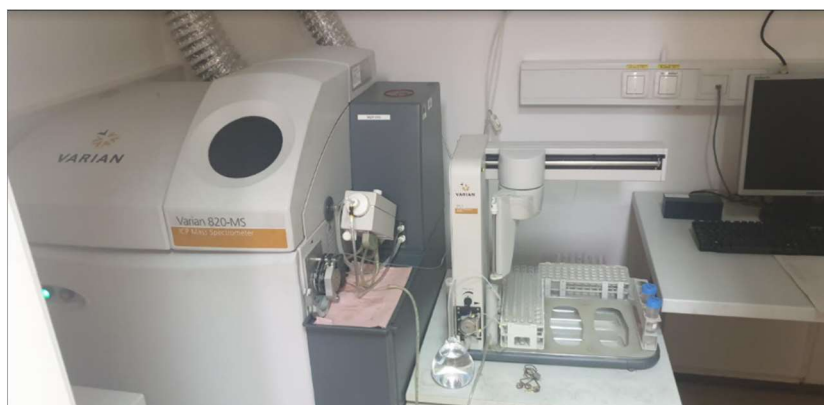
Slika 11: Aparatura za merjenje kovin (Jesenek, 2021)
