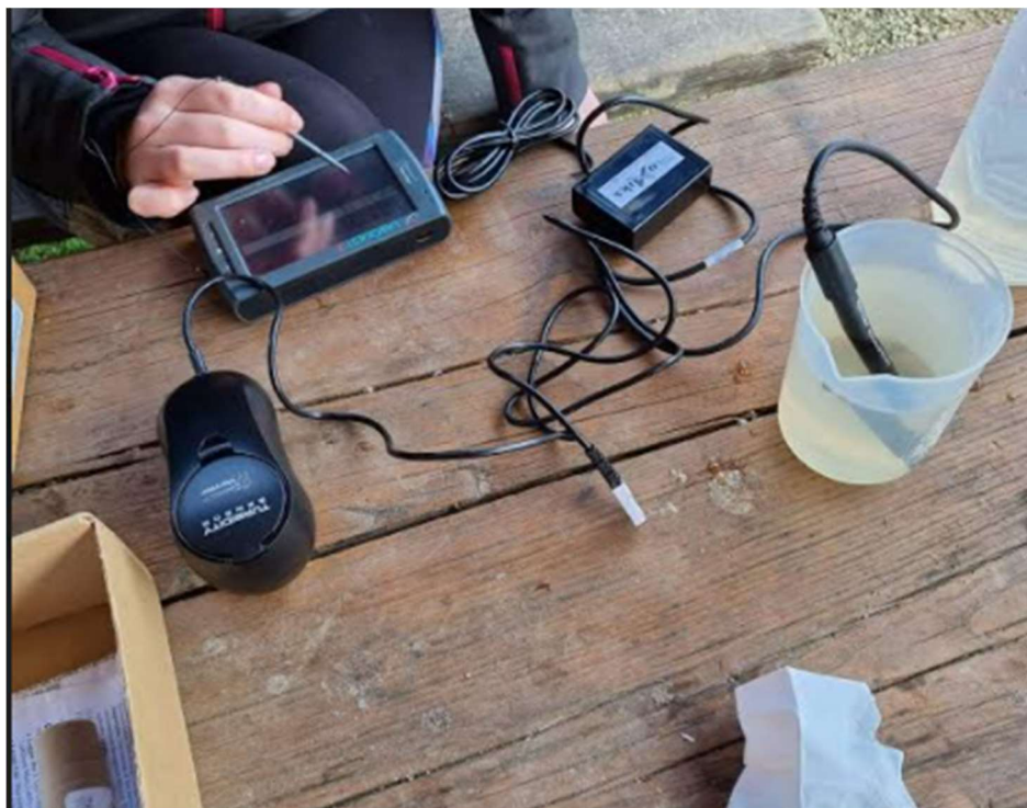
Slika 5: Analiziranje električne prevodnosti in motnosti na terenu (Jesenek, 2021)
