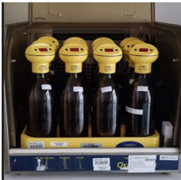
Slika 8: Komora z OXITOPI (Jesenek, 2021)
