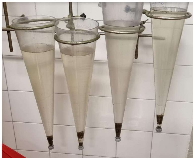
Slika 6: Določanje usedljivih snovi (Jesenek, 2021)
