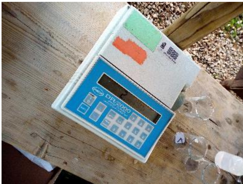
Slika 5: Prenosni spektrofotometer Hach DR/2000 (Foto: K. Ocepek, 2019)
