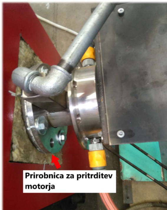
Slika 43: Pritrditev motorja v kurilno napravo
