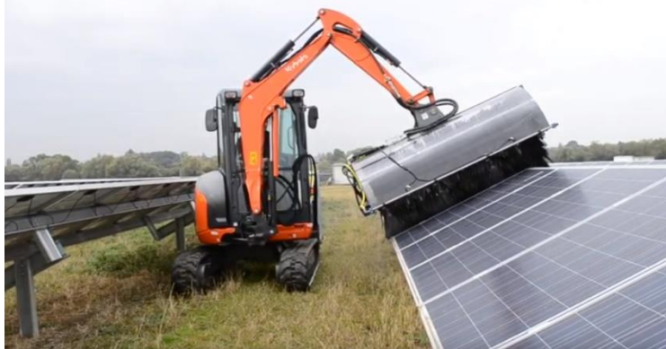
Slika 20: Čiščenje s pomočjo gradbenega stroja [13]
