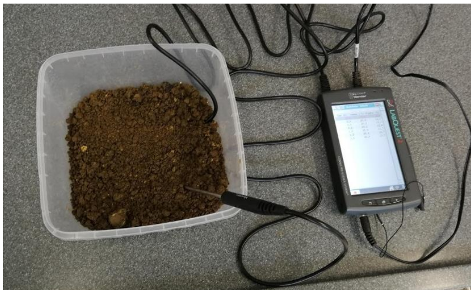
Slika 7: Merjenje temperature in vlage vzorca tal z elektronskim vmesnikom Vernier (foto: M. Globačnik, 2018).
