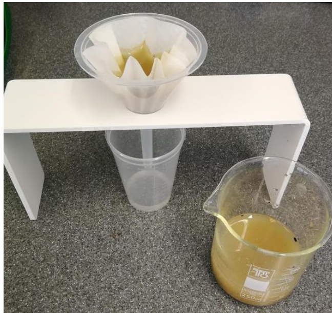
Slika 5: Postopek filtriranja ekstrakta pri določevanju pH tal (foto: M. Globačnik, 2018)
