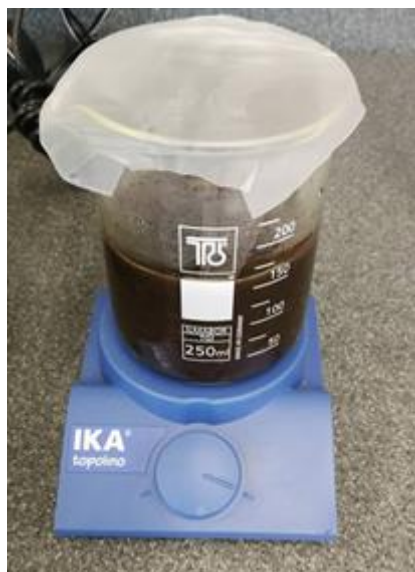
Slika 6: Ekstrakcija z magnetnim mešalom (foto: M. Globačnik, 2018)
