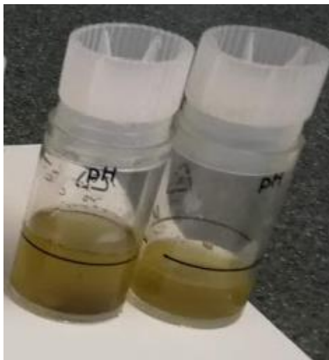
Slika 9: Rezultat meritve pH vzorca T2 s celotnimi in polovičnimi vrednostmi BREZ filtracije (foto: M. Globačnik, 2018)
