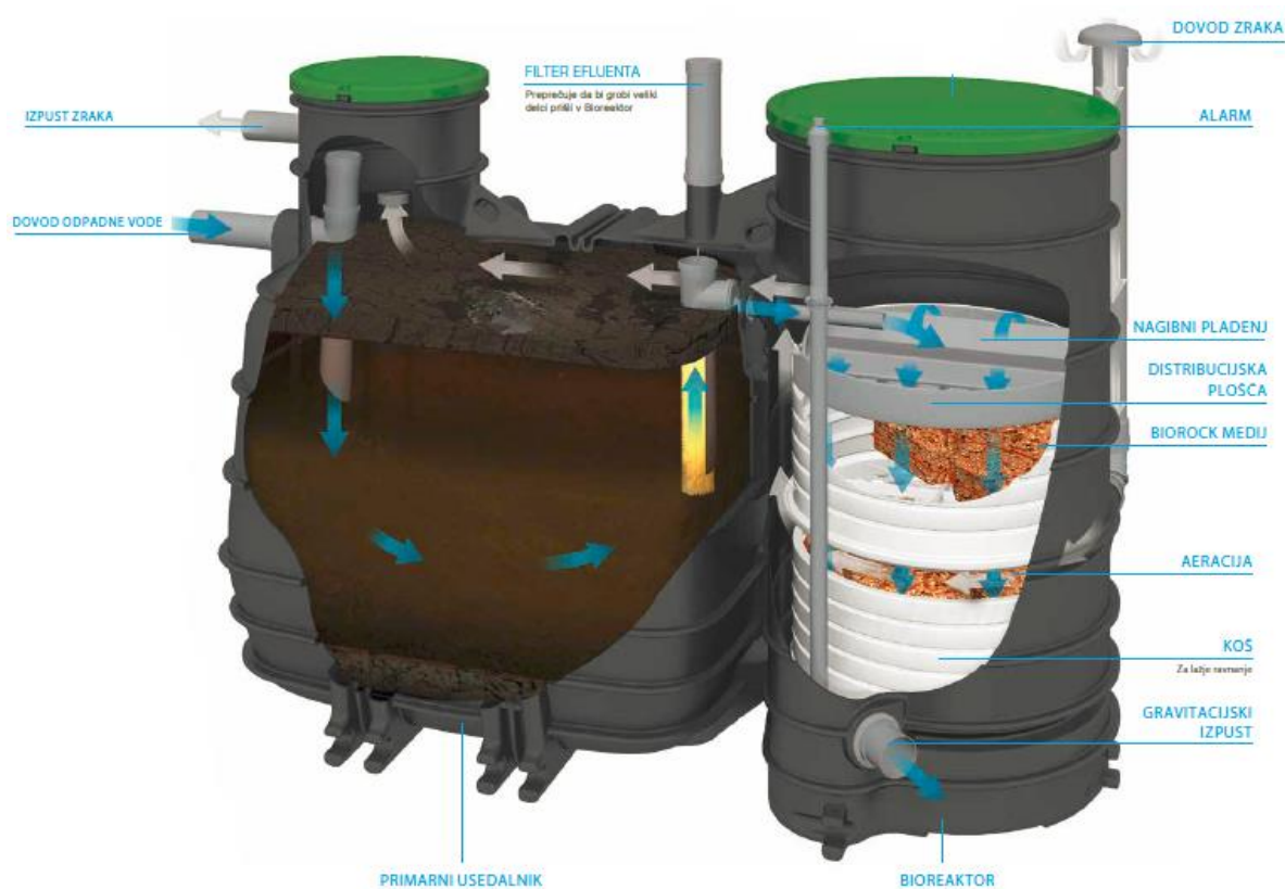
Slika 15: Delovanje čistilne naprave Biorock, (Foto: Biorock, medmrežje)
