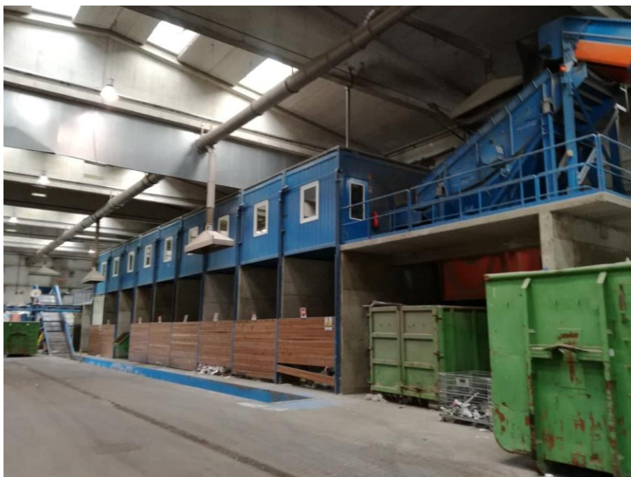
Slika 4 Sito, sortirnica, boksi za izločene frakcije
