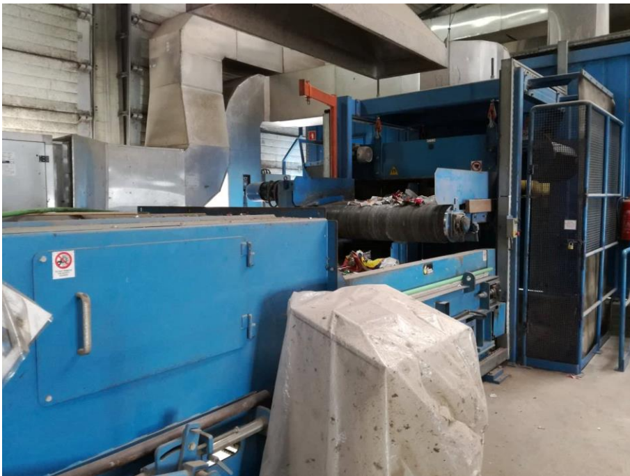
Slika 6 Magneta za železo in aluminij na koncu sortirnice
