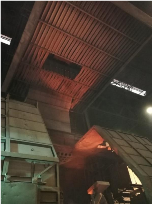
Slika 2: Zajem razpršenih emisij skozi napa nad elektroobločno pečjo
