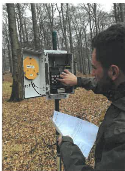
Slika 1 Kalibriranje mikrofona za spremljanje netopirjev
