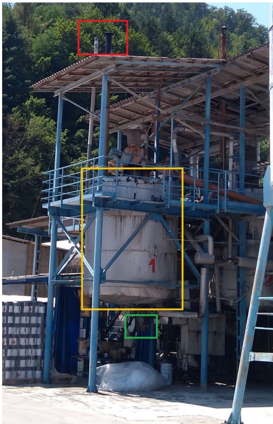
Slika 9: Vertikalna proizvodna linija za izdelavo bitumenskega premaza
