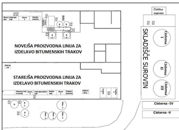
Slika 14: Shematski prikaz postrojitve proizvodnih linij in čistilne naprave
