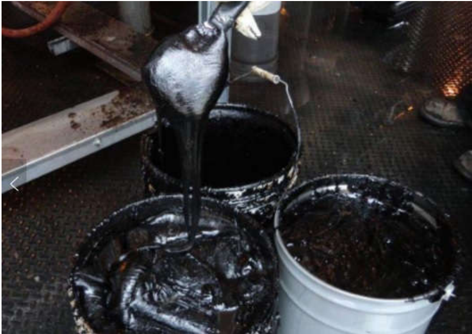
Slika 3: Tekoči bitumen pri temperaturi primerni za obdelavo
