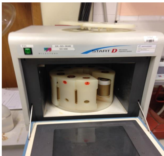
Slika 8: Vzorci so bili vstavljeni v rotor za mikrovalovni razklop, kjer so se približno po 55 minutah prenesli v merilne bučke (50ml) (Foto: Ž. Jankovič, 2017)
