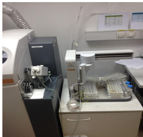
Slika 9: Analiza vzorcev je potekala na aparatu Varian 820-MS (ICP-MS) (Foto: Ž. Jankovič, 2017)
