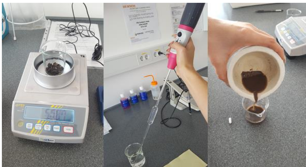
Slika 12: Merjenje pH substrata A in B (Vir: Ladan, 2016)
