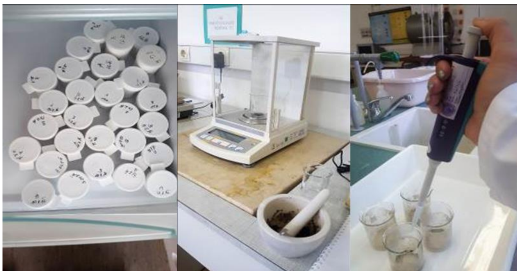
Slika 13: Merjenje TOC substrata A in B (Vir: Ladan, 2016)
