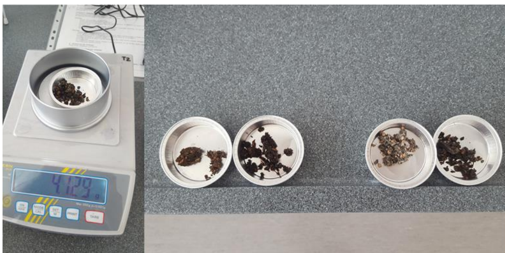
Slika 11: Merjenje vlage substrata A in B (Vir: Ladan, 2016)
