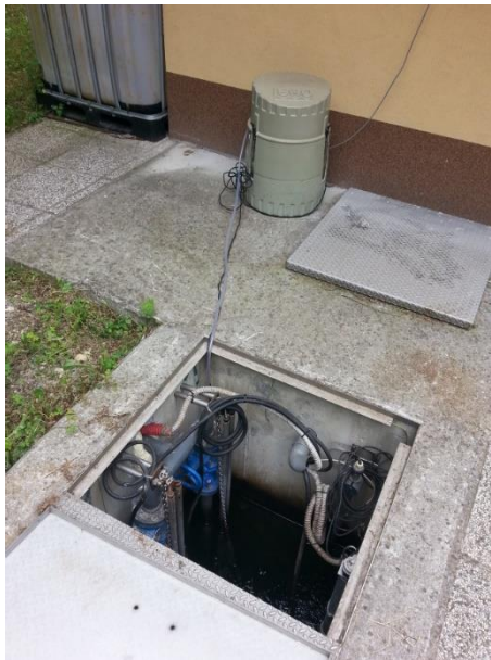
Slika 11: Vzorčenje iztoka s prenosnim samodejnim vzorčevalnikom (vir: osebni arhiv)
