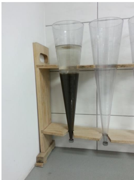
Slika 15: Sedimentacijski lij za merjenje usedljivosti (vir: osebni arhiv)
