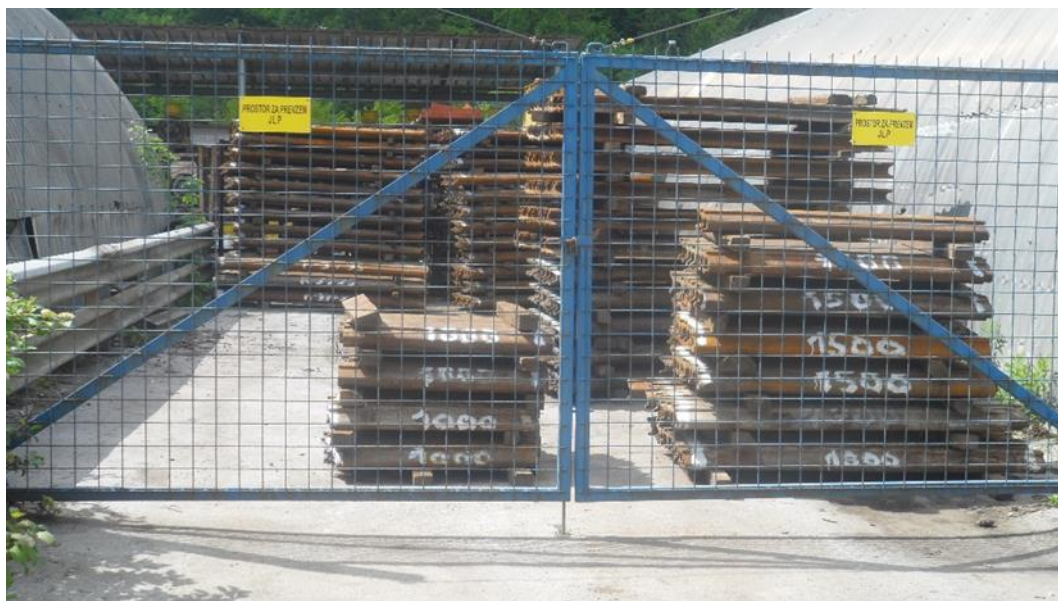
Slika 7: Popravljeno jamsko ločno podporje.
