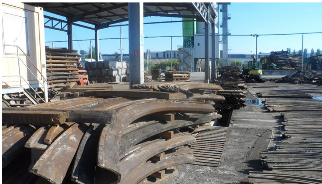
Slika 5: Prostor za čiščenje in pripravo jamskega ločnega podporja.
