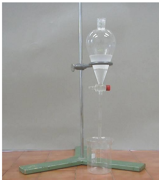
Slika 2: Ekstrakcija PAO iz vodne faze z diklorometanom (Vir: Nacionalni laboratorij za zdravje, okolje in hrano, 2015)
