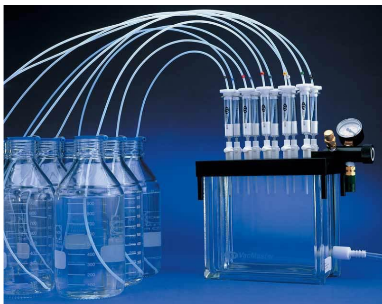
Slika 16: Ekstrakcija PAO z uporabo kolon ISOLUTE PAH. (Vir: Supelco, 2015)
