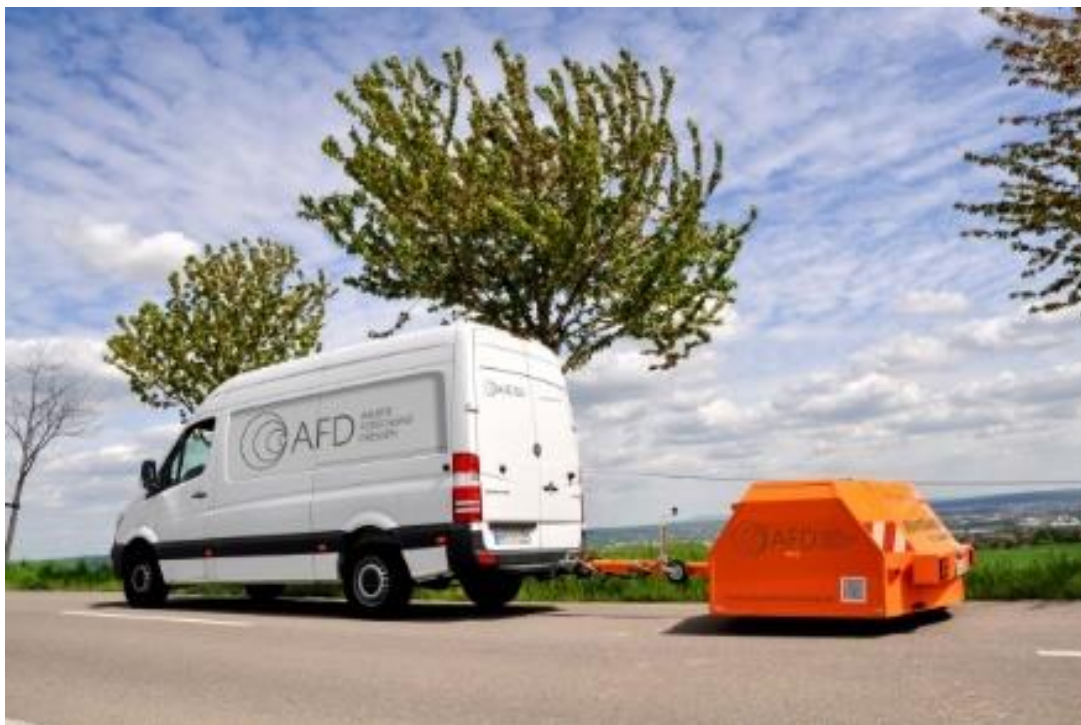
Slika 6: Merjenje hrupa pnevmatik z merilno prikolico (Vir: Medmrežje 7)
