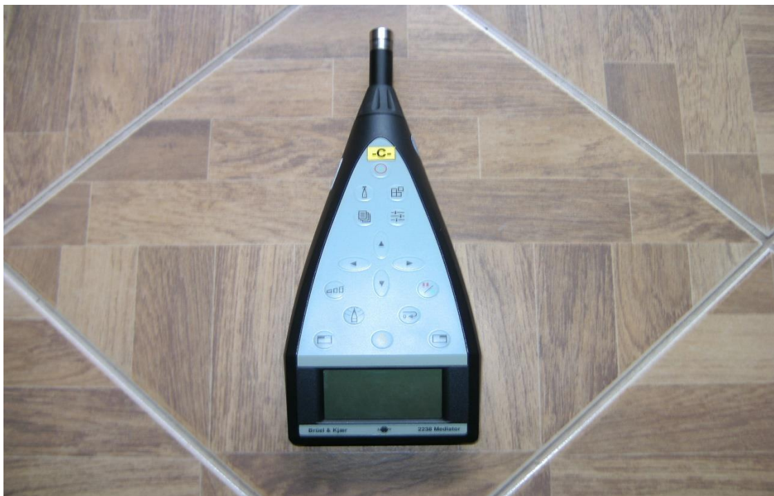
Slika 16: Inštrument za merjenje hrupa Brüel & Kjær, tip 2238 Mediator (Vir: Lasten)
