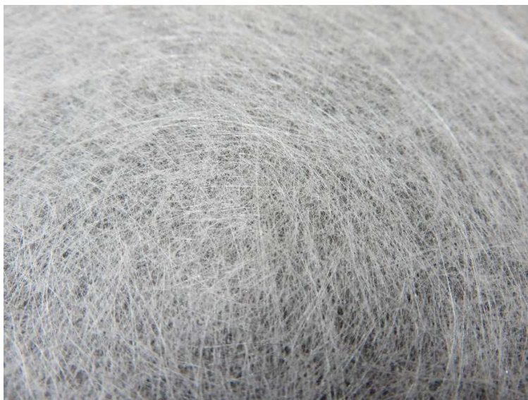
Slika 18: Struktura steklenega voala Vir: K. Novak, 2015
