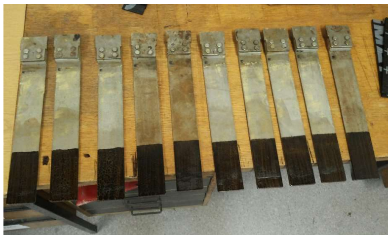
Slika 21: Nanos ekološkega hladnega bitumenskega osnovnega premaza na kovinske ploščice Vir: K. Novak, 2015
