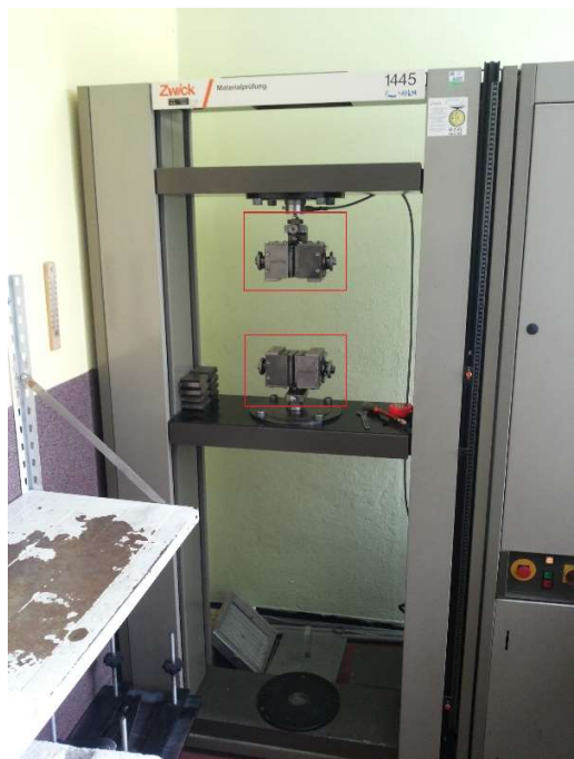
Slika 20: Trgalni stroj dinamometer in z rdečo barvo označen prijemalni sponi Vir: K. Novak, 2015
