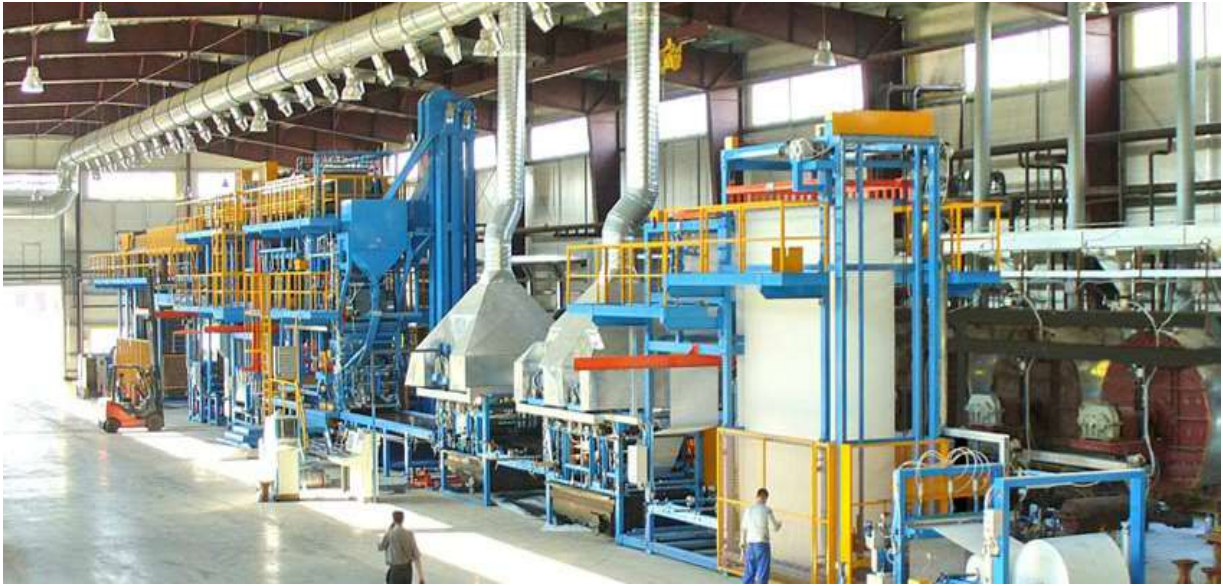
Slika 8: Tehnološka postavitve proizvodne linije za izdelavo hidroizolacijskih trakov Vir: Boato International, 2014
