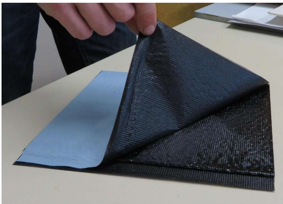
Slika 17: Primer razslojenega vzorca samolepilnega bitumenskega hidroizolacijskega traku Vir: K. Novak, 2015
