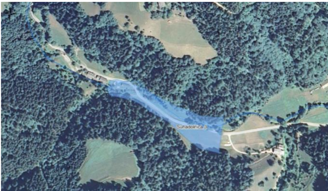
Slika 9: Načrtovana gradnja suhega zadrževalnika Suhodolnica 3. Vir: Globevnik in sod. 2014, str. 103
