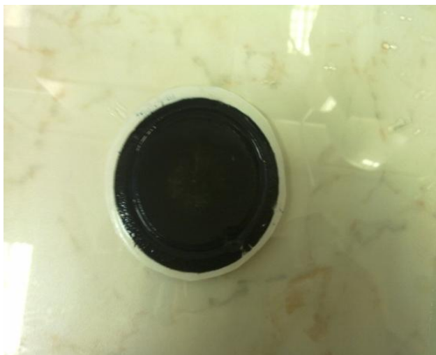
Slika 7: Prikazana zamašena membrana UFx-pHt Vir: Osebni vir, 2012
