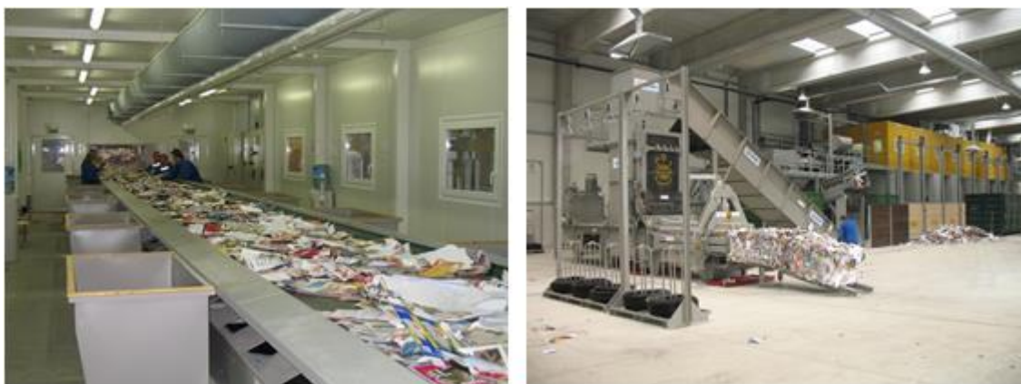
Slika 7: Sortirna linija, balirka (Vir: Interni vir RCERO Celje, 2009)
