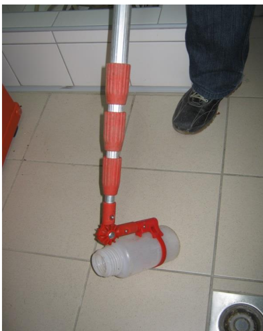
Slika 15: Zajemalo za odpadno vodo s podaljškom (Vir: Avtor, 2013)
