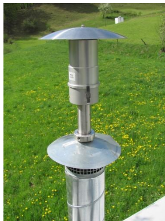
Slika 20: Glava PM 10 -merilnika SM-200 (Vir: Hohnc, 2011)
