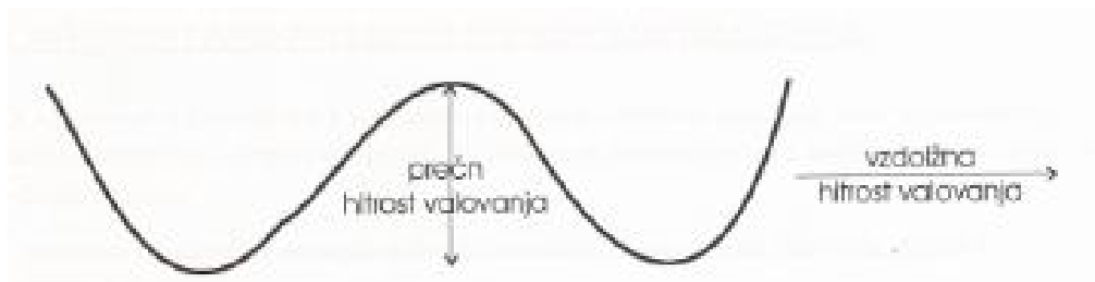
Slika 24: Prečna in vzdolžna hitrost valovanja
