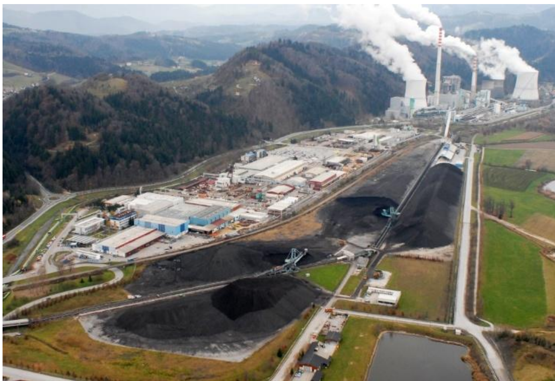
Slika 3: Deponija premoga z deponijskimi stroji in transportnimi trakovi, ki transportirajo premog v TE Šoštanj (Vir: Medmrežje 14)
