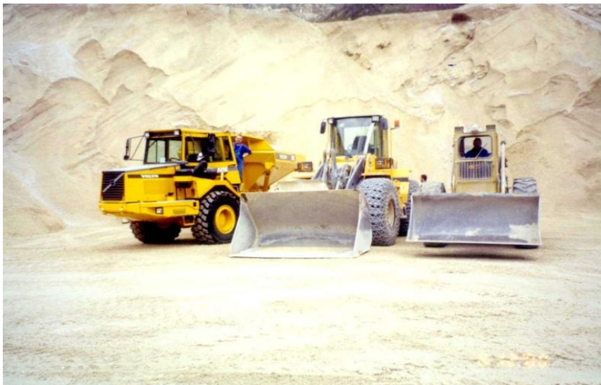
Slika 8: Pridobivanje kamene surovine oz. apnenčeve moke za čiščenje SO_2 iz dimnih plinov, ki nastajajo pri zgorevanju premoga (Vir: Majda Čujež, 2006)
