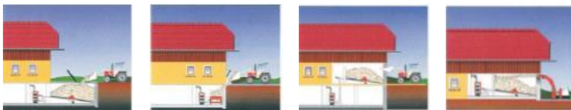
Slika 6: Skladiščenje in transport lesnih sekancev do kotla (Vir: Hrovatin in Šubic, 2000)
