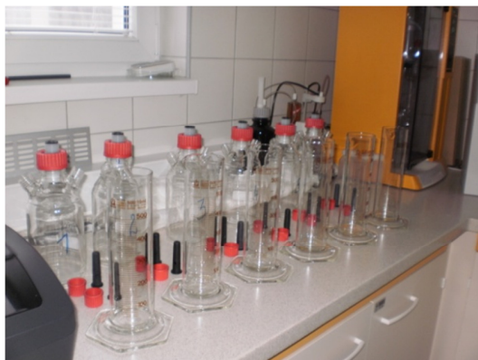
Slika 2: Steklovina, pripravljena za preskus anaerobne razgradnje blata
