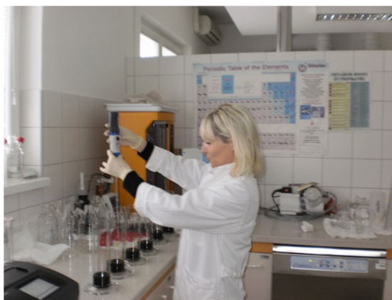
Slika 3: Priprava vzorcev za analizo anaerobne razgradnje blata
