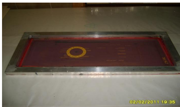
Slika 12: Izdelano sito (vir: lastni)
