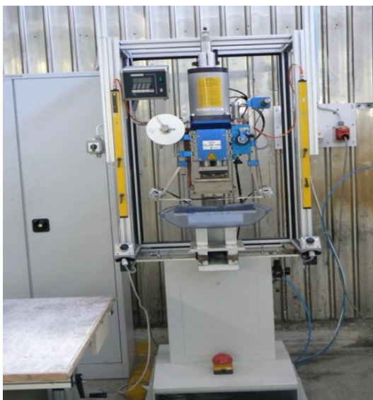
Slika 8: Stroj za vroči tisk (vir: lastni)
