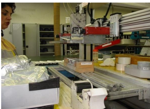
Slika 4: Strojni sitotisk (vir: lastni)
