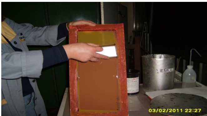
Slika 11: Oslojevanje sit (vir: lastni)
