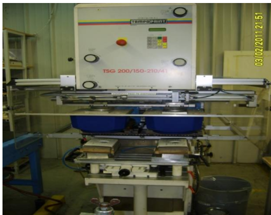
Slika 6: Tamponski tisk vložka čelne plošče pralnega stroja (vir: lastni)
